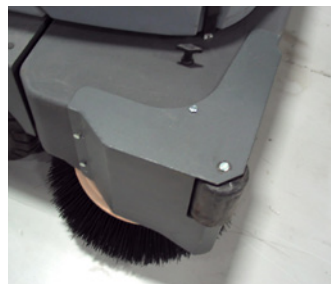
Hoekbeschermers zijborstel Beschermt zowel machine als zijborstel
