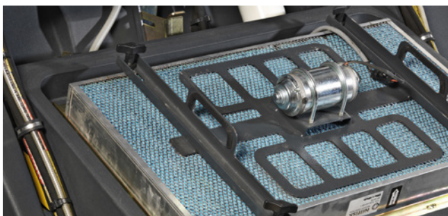
Filters Papieren filter: Werkt goed in droge omgevingen en bij hoge stofconcentraties. Polyester: Werkt goed onder vochtige omstandigheden, is uitwasbaar en daardoor herbruikbaar
