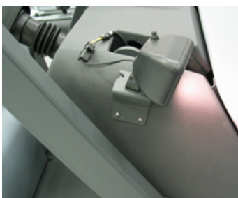
Werkverlichting voor Deze verlichting geeft extra zicht op de vloer, ondersteunt de gewone verlichting
