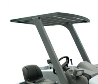
Chauffeursbeveiliging Beschermt de bestuurder
