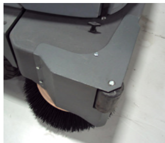
Hoekbeschermers zijborstel Beschermt zowel machine als zijborstel
