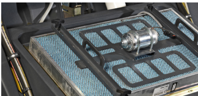
Filters Papieren filter: Werkt goed in droge omgevingen en bij hoge stofconcentraties. Polyester: Werkt goed onder vochtige omstandigheden, is uitwasbaar en daardoor herbruikbaar
