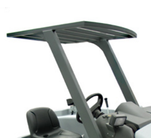
Chauffeursbeveiliging Beschermt de bestuurder
